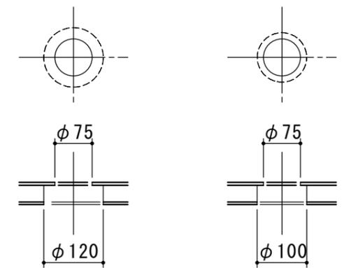
⑮電極口部孔明詳細 ⑨通気口部孔明詳細
